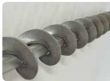
Die 70 mm Edelstahl-Förderschnecke bietet einen effektiven und gleichmäßigen Materialfluss zum Drehteller. Die gesamte Schneckenbaugruppe kann bei Bedarf leicht entfernt werden.
