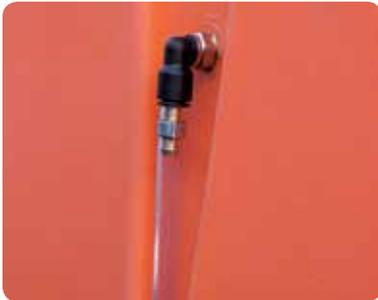
Salzlösungs-Füllstandsprüfung für optionale Vorbefeuchtung auch mit elektronischem Sensor.
