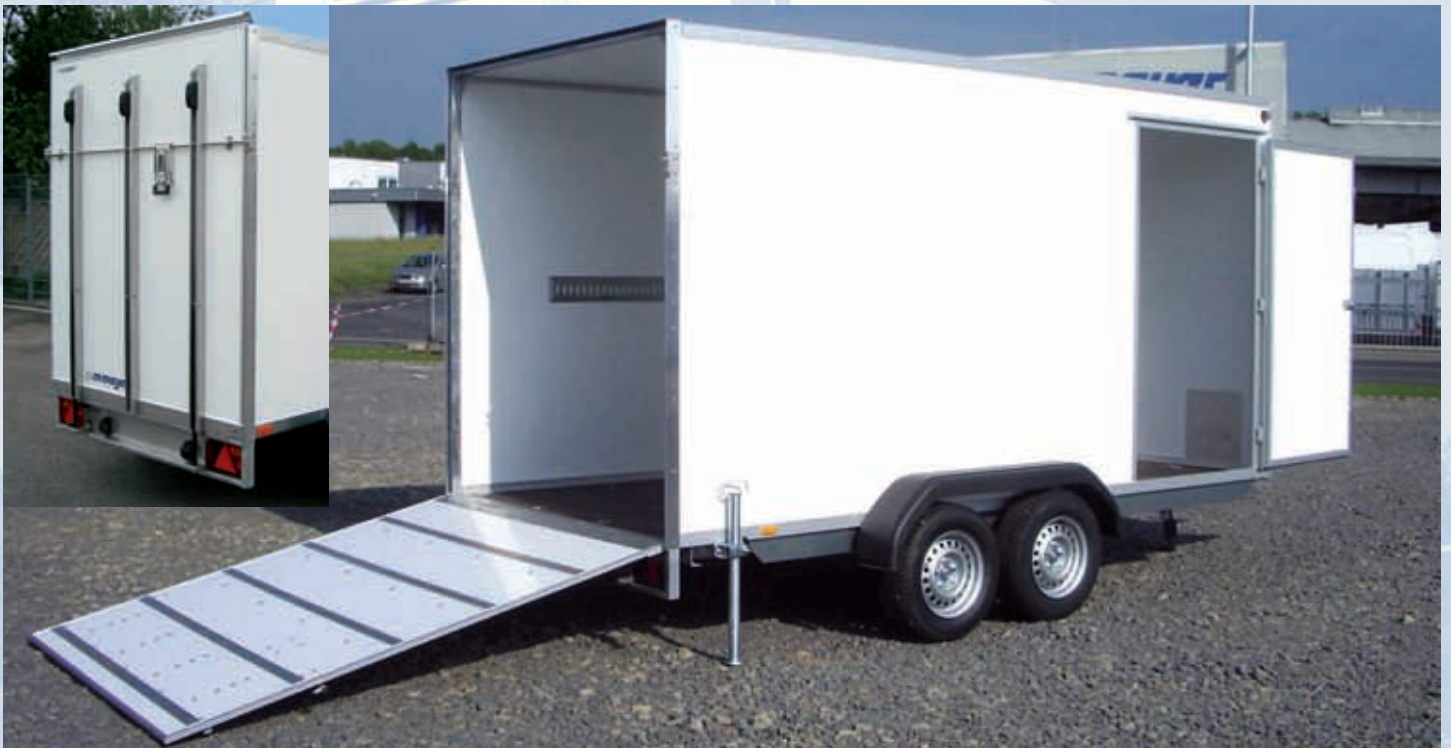
AZ 2540/185 Serie 50 Zubehör: Rampe mit Edelstahltraversen und -drehstangenverschluß (V2A), Heckschiebestützen links und rechts, Seitentür vorne rechts, Zurrleisten aufgesetzt, Reserveradhalter an Stirnwand rechts AZ 2540/185 Série 50 Accessoires : rampe avec traverses et serrure en inox, béquilles arrière à gauche et à droite, porte latérale avant droite, rails de fixation sur panneau gauche et droit, support pour roues de secours monté au panneau avant à droite AZ 2540/185 Series 50 Optional extras: ramp with stainless steel crossbars and closing system, rear prop stands left and right, side door front right, load locking bars on side panels left and right, spare wheel support fitted on right-hand side of front panel
